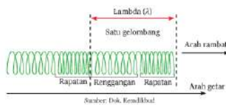
Gambar 2. 3 Rapatan dan Renggangan pada Gelombang Longitudinal
