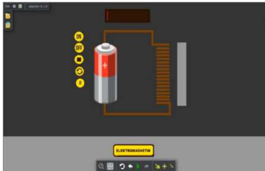
Gambar 2. 16 Simulasi Cara Membuat Magnet: Elektromagnetik
